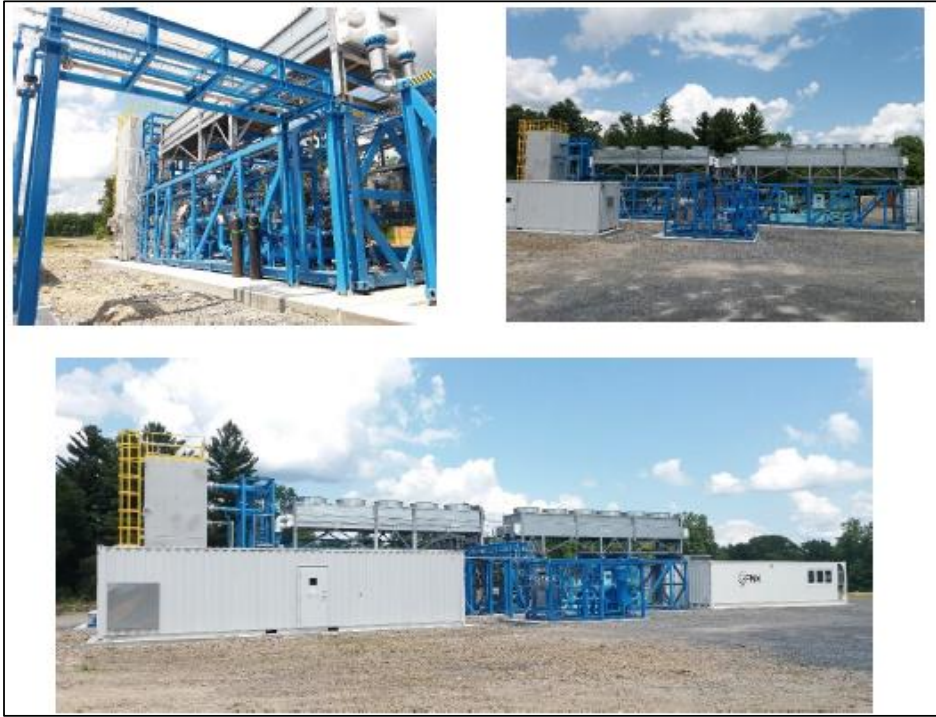
Ilustración 30. Ejemplo de equipo modular de licuefacción de metano.
